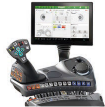
Power+ Setting 1 - Sans levier en croix - deux paires de commandes en ligne pour actionner les distributeurs hydrauliques
