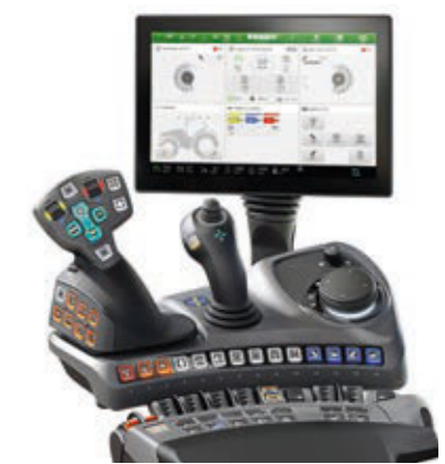
Profi Setting 2/ Profi+ Setting 2 - Joystick 3L - deux paires de commandes en ligne pour actionner les distributeurs hydrauliques
