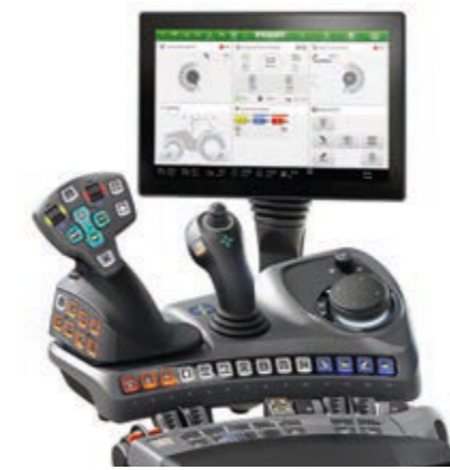
Power+ Setting 2 - Joystick 3L - une paire de commandes en ligne pour actionner les distributeurs hydrauliques
