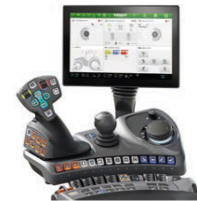
Profi Setting 1/ Profi+ Setting 1 - Levier en croix - deux paires de commandes en ligne pour actionner les distributeurs hydrauliques
